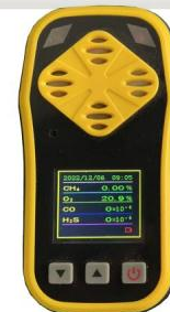
JD4矿用多参数气体检测报警仪
