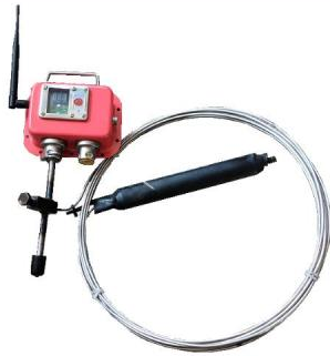
GZY60矿用本安型钻孔应力传感器
